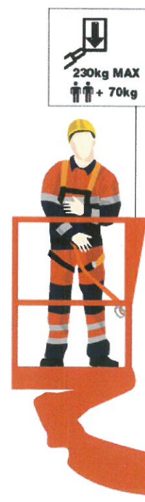
Rys. 2. Informacja o dopuszczalnym obciążeniu platformy podestu ruchomego
